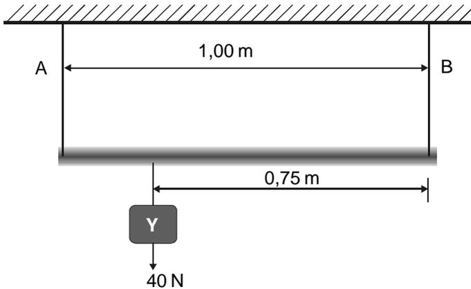
Considerando-se que a barra é homogênea e pesa 100 N, as tensões nas cordas **A** e **B** são, em newtons, respectivamente,
