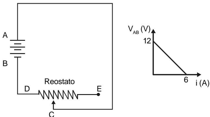
Quando a corrente  $i$  vale 2,0 A, a potência dissipada no reostato, em watts, é
